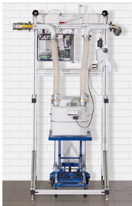
Prüfstrecke für Gewerbegaszähler
